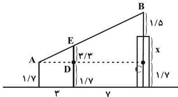
$$\text{قضیه تالس } DE \parallel BC \Rightarrow \frac{AD}{AC} = \frac{DE}{BC} \Rightarrow \frac{3}{10} = \frac{3/3}{x+1/5}$$
